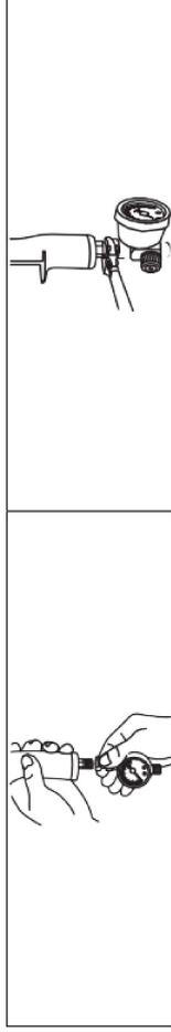
2 Schließen Sie den Flüssigkeitsschlauch an die Basis der Lackierpistole an.
